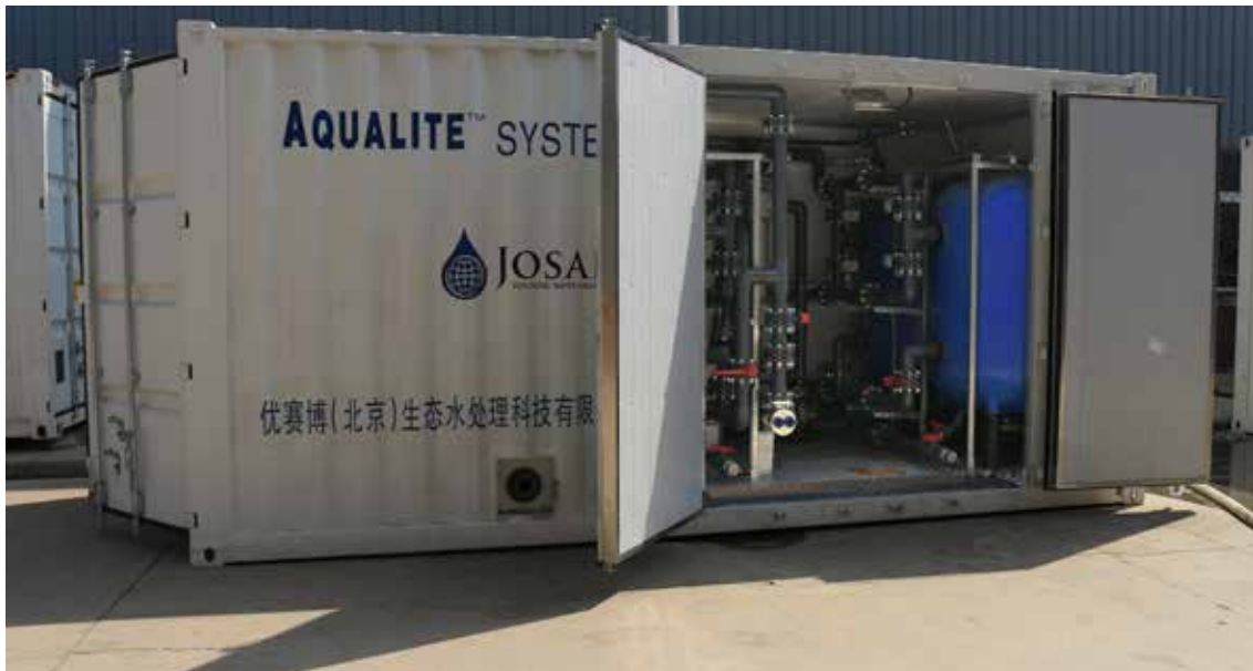
Container med vattenreningsenhet, SC900, med en kapacitet om 600-1.000m 3 per dygn. Det containerbaserade standardsortimentet uppvisar en kapacitet på 100-3.000m 3 per dygn.
