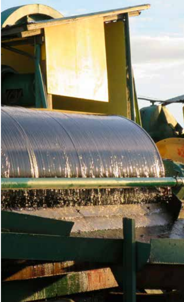
Separation av magnetit med hjälp av magnetseparatorer.
