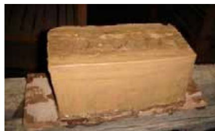
Tegelsten producerad av slime inför bränning.
